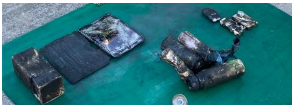
図 5-44 1月5日の火災の原因だと考えられるスプレー缶、リチウム蓄電池使用機器(埼玉県坂戸市)
