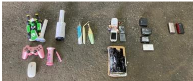
図 5-41 燃やさないごみに混入していたリチウム蓄電池等(埼玉県坂戸市)
